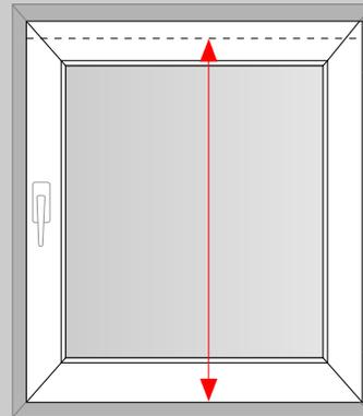
Messen Sie die Rahmenhöhe von der unteren Außenkante des Rahmenprofils bis Mitte des oberen Rahmenprofils und ziehen Sie 0,5 cm ab. Somit erhalten Sie Ihre Bestellhöhe.
